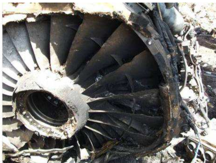
Présence de bois, de fibres et d'un panneau d'aube derrière la RM1
