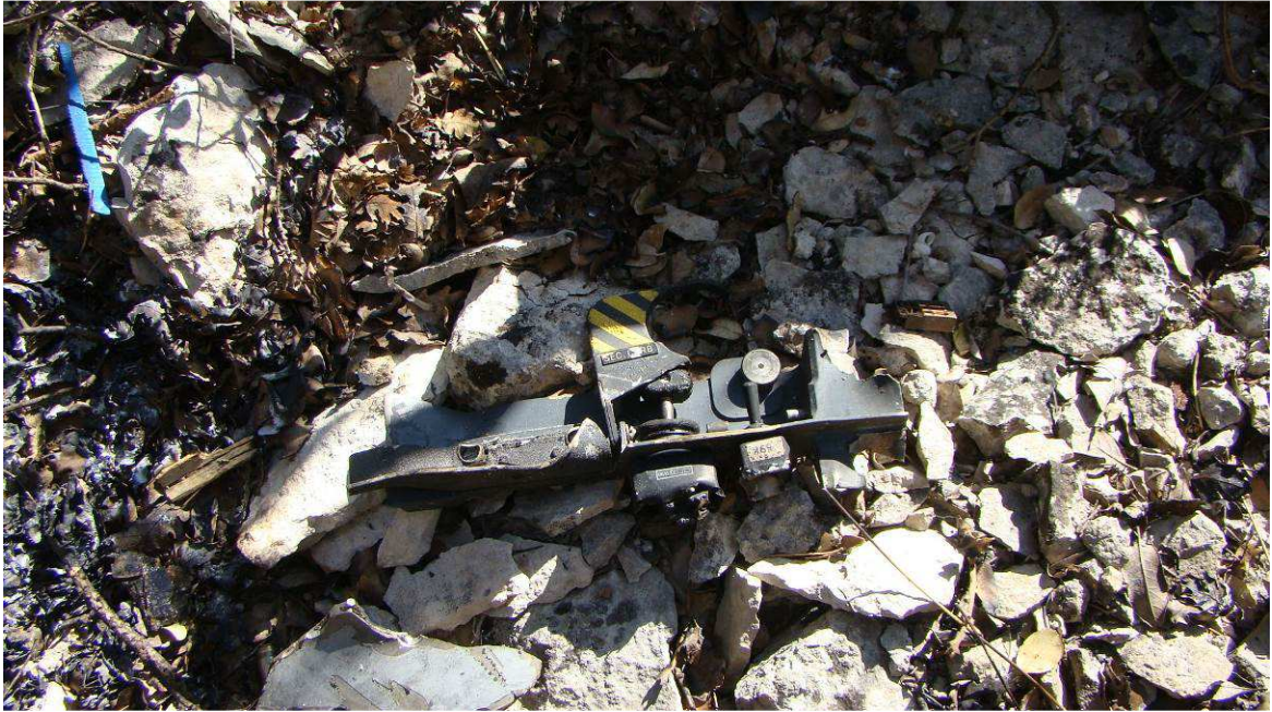
Vue de la palette secours carburant
