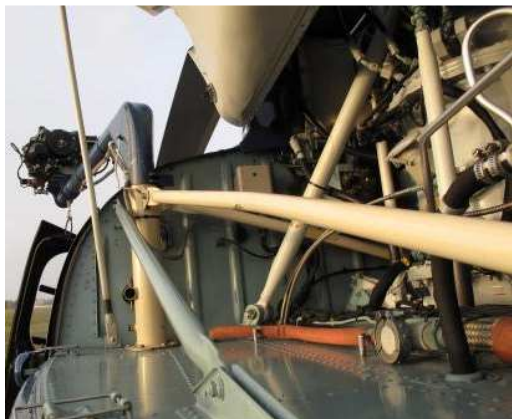
Déformation de la contrefiche de potence du treuil
