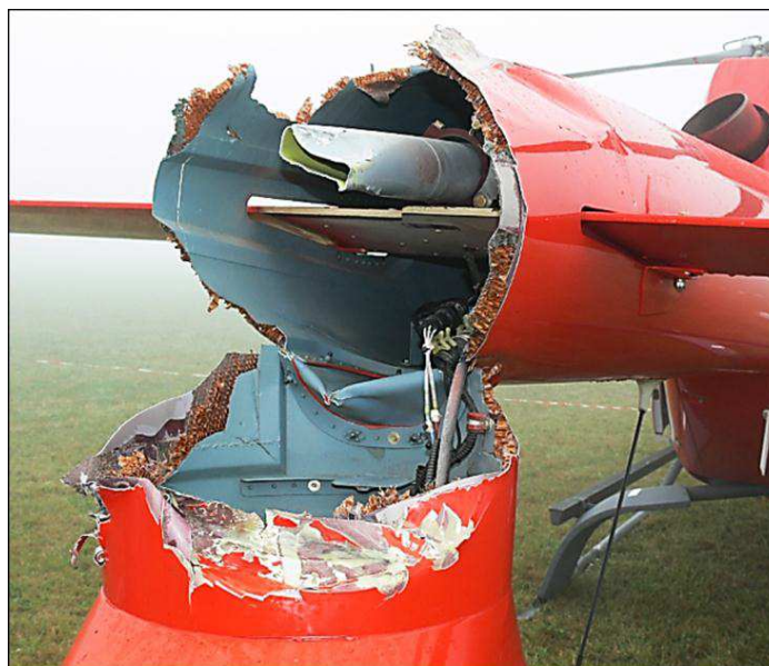
Poutre de queue sectionnée
