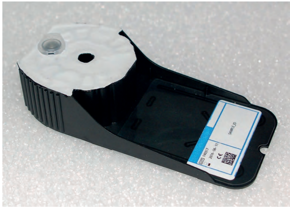
Figure ① Prototype de cartouche contenant les réactifs nécessaires à l'analyse
