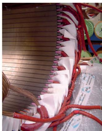
MADA 300kW en cours de bobinage et vue en coupe
