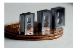
Les horloges atomiques actuelles servent notamment à synchroniser les réseaux de communication. Pour bénéficier des qualités de ces horloges, une architecture miniaturisée a été développée afin d'étendre leur utilisation à des dispositifs portatifs et nomades. (Trois cellules d'horloge présentées sur une pièce de 5 centimes €).
