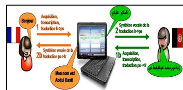
Ce système permet de tenir des conversations simples dans de nombreuses langues sur des théâtres d'opération. La solution de traduction tient sur un mini PC portable équipé de micros casques externes. Elle ne nécessite pas de connexion Internet. TRAD propose un dispositif complet de dialogue, utilisable selon plusieurs scénarios préétablis, mais non exhaustifs, comme le passage de check-point, des questions médicales, un accident sur la voie publique...
