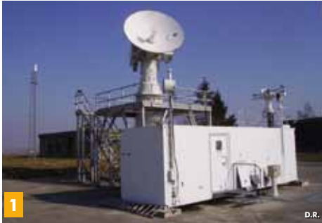
1. Radar Suivi et acquisition de trajectoires avion et munitions (SATAM).
