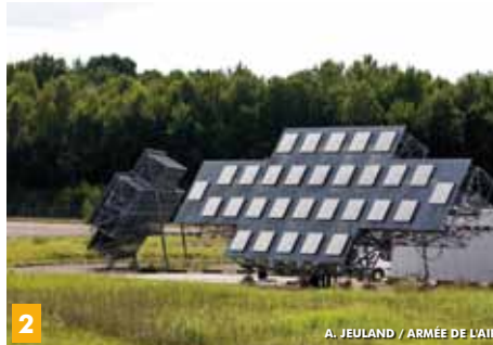
1. Radar Suivi et acquisition de trajectoires avion et munitions (SATAM).
