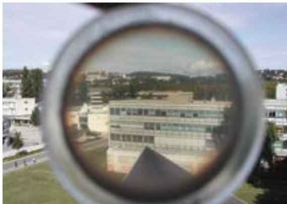
Fig. ① : échantillon de spinelle diamètre 40 mm, épaisseur 7 mm.
