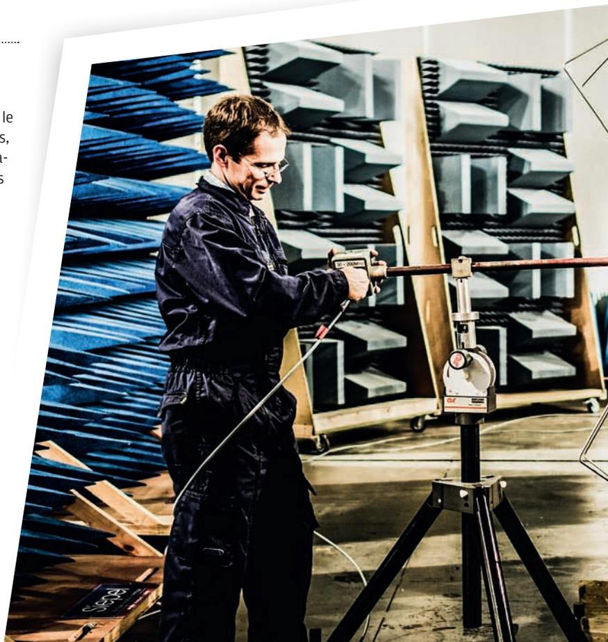
Montage d'une antenne récupérant le rayonnement électromagnétique du VHM (Véhicule haute mobilité) en fonctionnement. →
