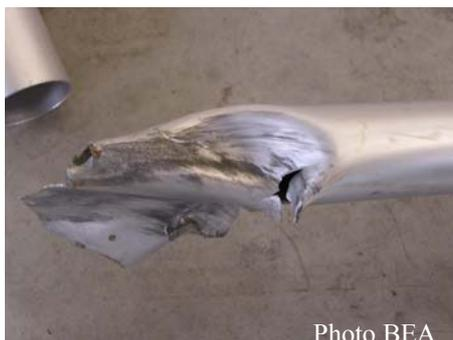
Photo 8 : extrémité du tube de saumon de l'aile de l'ULM
