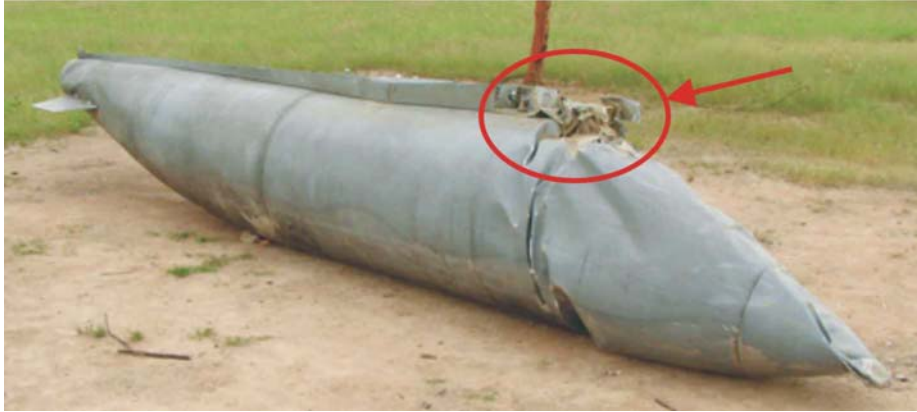
Photo 8 : choc d'un volatile au niveau du raccord du réservoir pendulaire largable (RPL) et de la poutre ventrale
