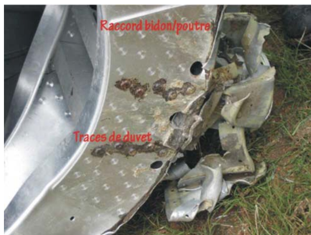
Photo 11 : pénétration d'une partie du volatile dans le réservoir pendulaire largable
