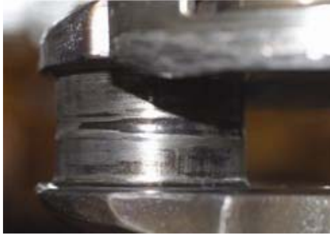
Photo n° 6 : Aspect du maneton de la bielle n° 5 usé en son milieu par les boulons de la bielle
