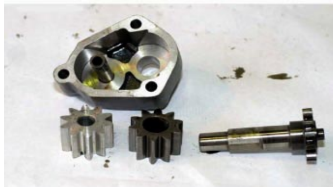
Photo n° 4 : Pompe à huile en bon état.
