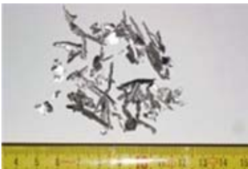
Particules d'alliages anti-friction sous forme d'agglomérats tassés et écrasés.
