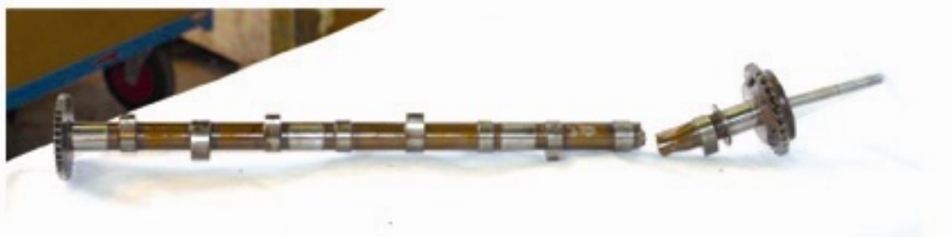
Photo n° 9 : Arbre à cames brisé entre les soupapes d'admission et échappement du cylindre n °6
