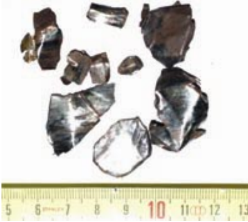
Particules les plus volumineuses provenant des coussinets en acier
