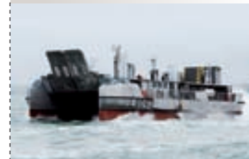
Basé sur un concept unique au monde, l'EDA-R est un catamaran qui se transforme en navire à fond plat pour le débarquement des hommes et du matériel.
