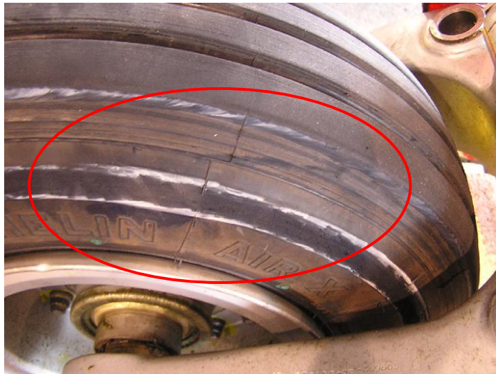
Photo 4 : Traces de frottement sur le pneumatique avant
