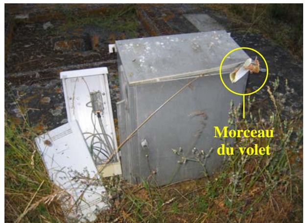
*Photo 4 : impact sur l'armoire électrique*
