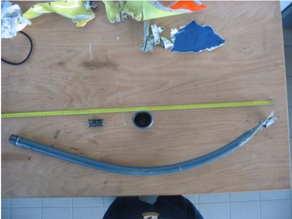
Tronçon d'arbre sectionné et éjecté et cloche arrière d'accouplement sur la BTA
