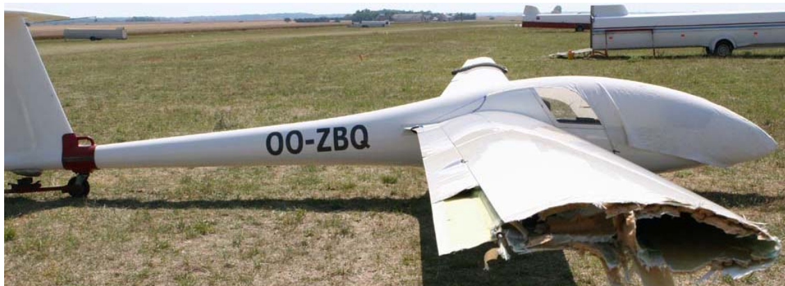
Vue des dommages sur l'aile droite
