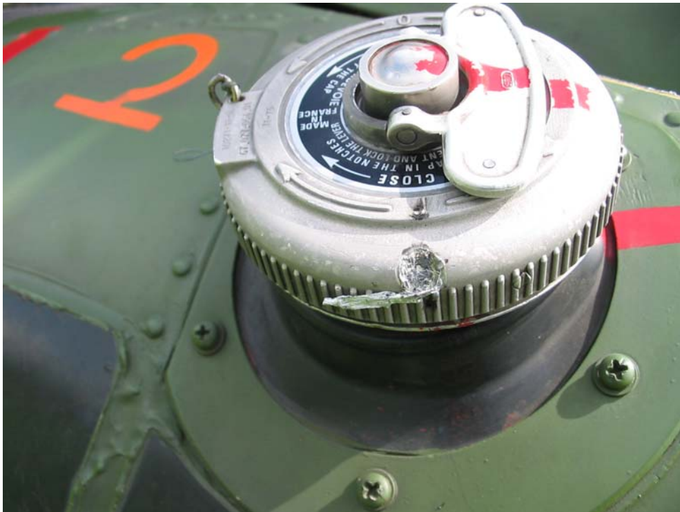
Marquage arc électrique sur bouchon réservoir
