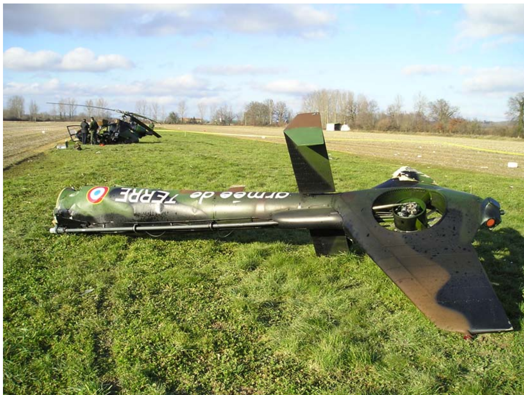
Etat de la poutre de queue
