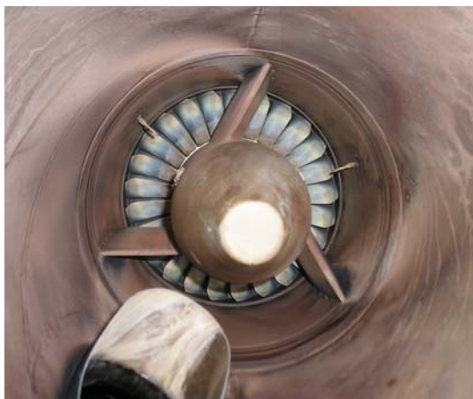
Dernier étage turbine
