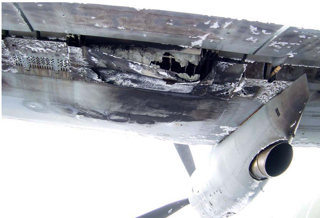
Vue de l'intrados Le réservoir est perforé et brûlé
