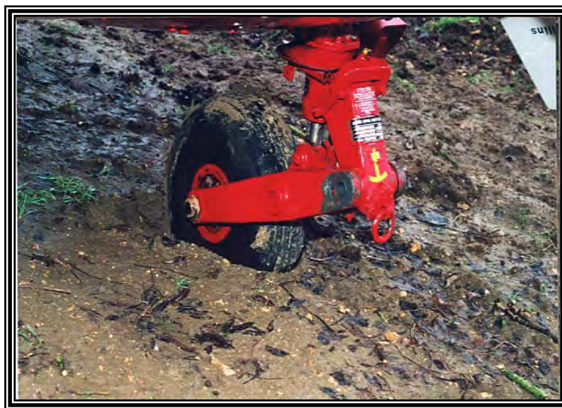
Enfoncement de la roue avant au deuxième poser
