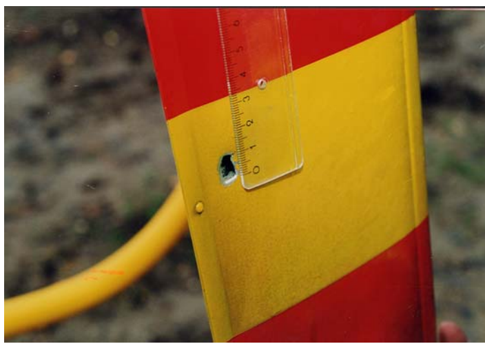
Pale du rotor anticouple perforée
