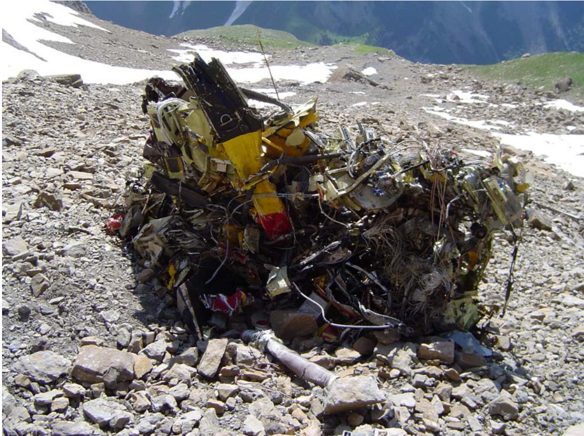
Photo 7 : débris de la cellule
