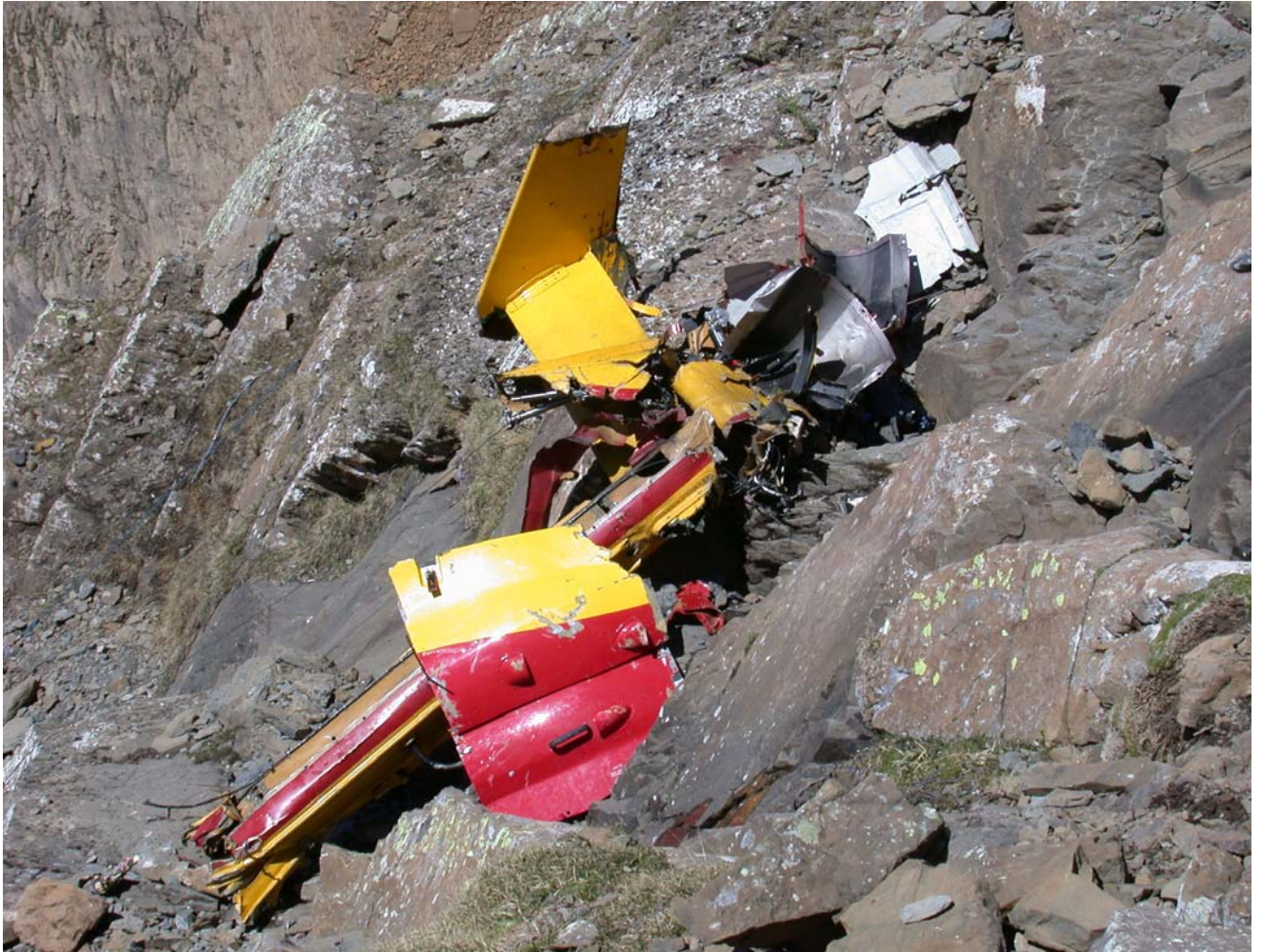
Photo 6 : débris de la poutre de queue
