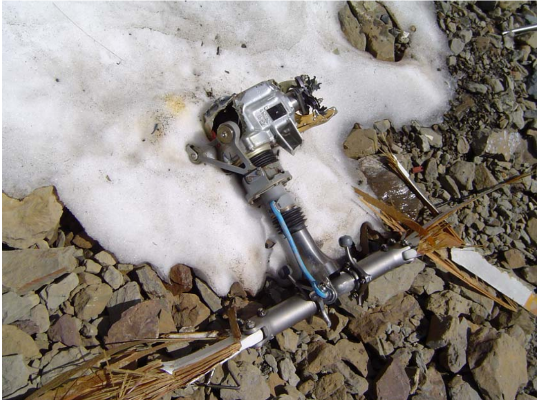
Photo 8 : débris de la BTA et du RAC
