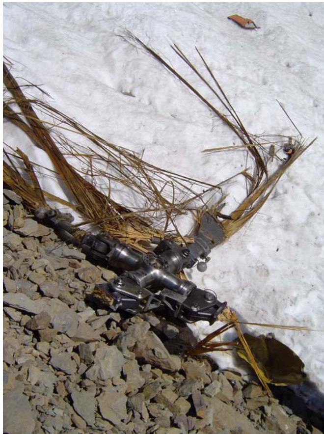
Photo 9 : débris du rotor principal
