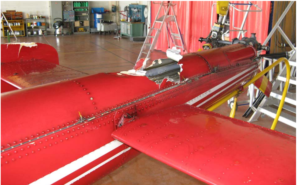
Photo 3 : capot intermédiaire de protection de l'arbre de transmission déchiré
