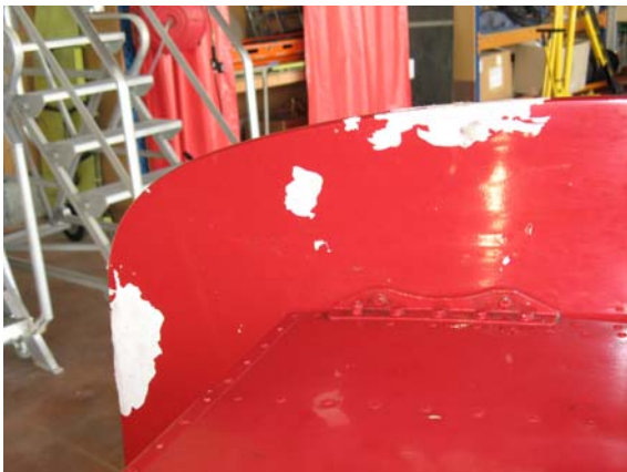
Photos 5 et 6 : dérives verticales gauche et droite endommagées
