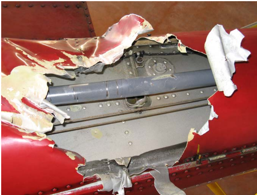
Photo 4 : vue détaillée du capot de protection déchiré et des rayures sur l'arbre de transmission
