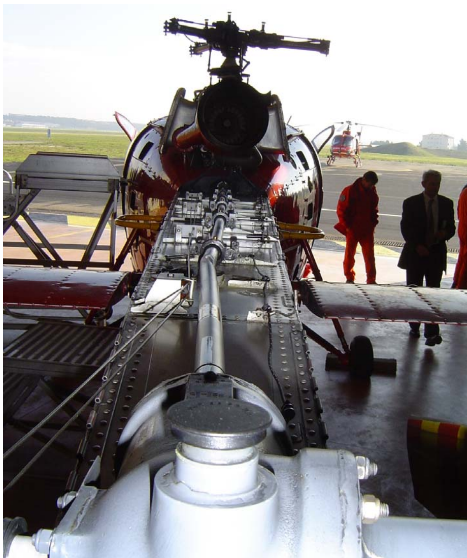
Photo 8 : vue générale de l'arbre de transmission horizontal
