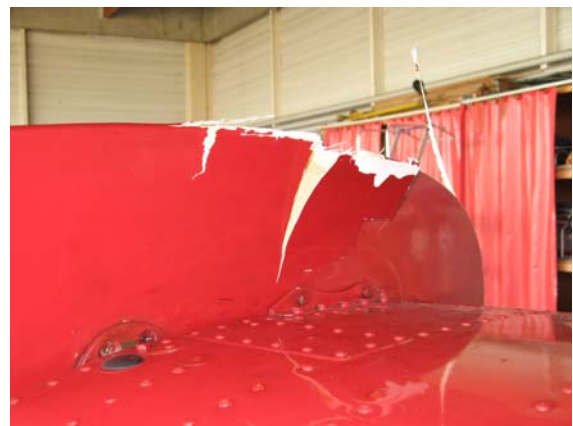
Photos 5 et 6 : dérives verticales gauche et droite endommagées
