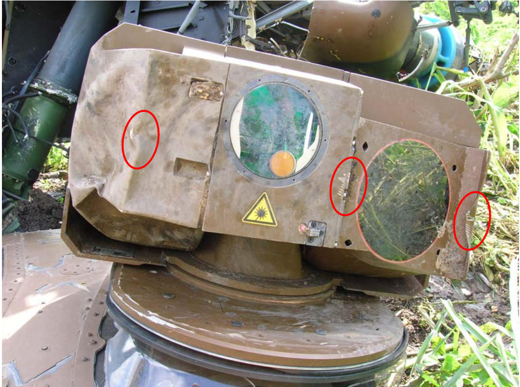
Traces d'impact de câble sur la TDV
