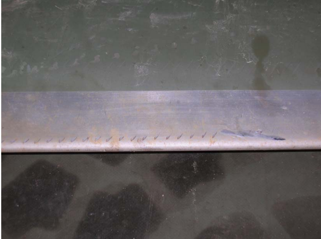
Marquages sur le bord d'attaque de la pale bleue
