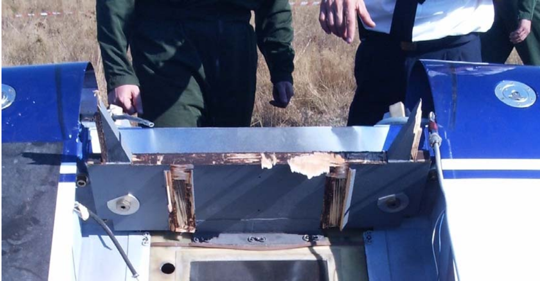
Détail de la rupture du cadre 2 (avant)
