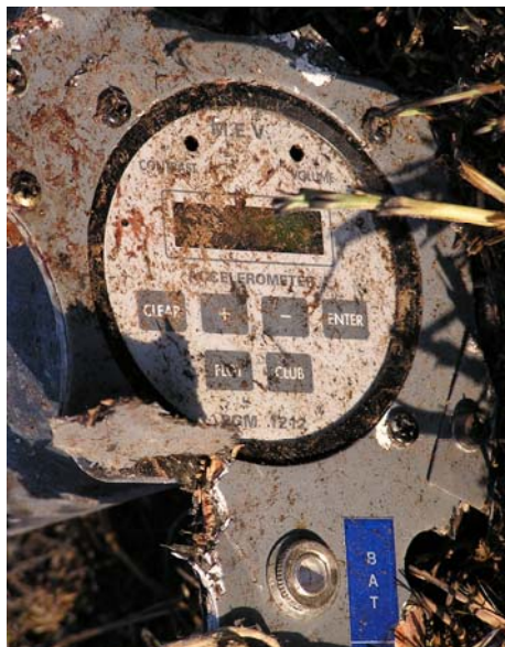
Vue de l'accéléromètre PGM 1212 tel que retrouvé
