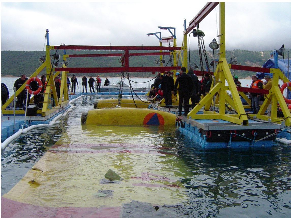
L'aile remontée à la surface du lac grâce à la plateforme
