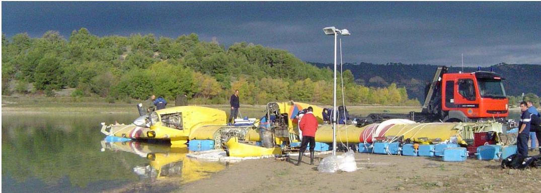
Aile au cours de la découpe et de la dépose des moteurs
