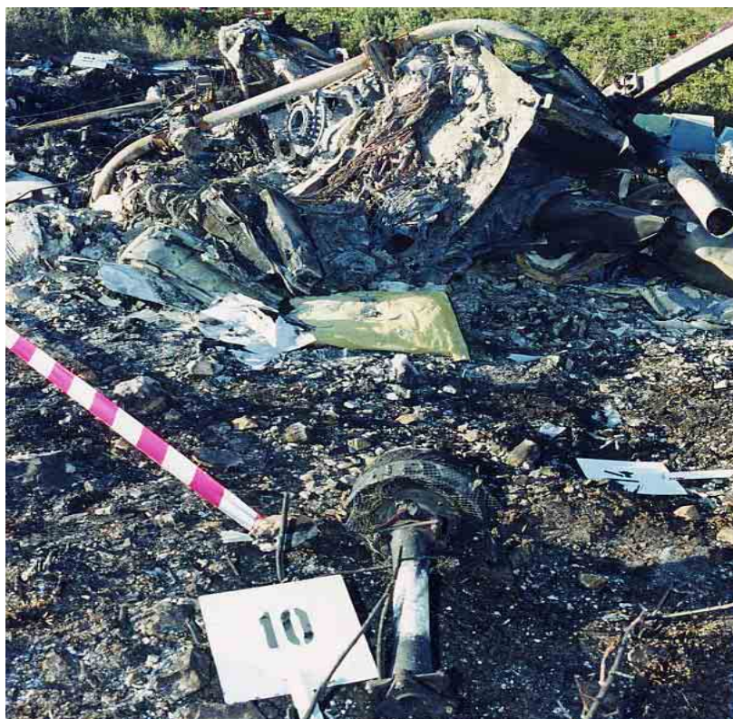
Début transmission arrière et ventilateur
