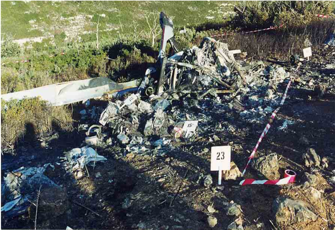
Vue épave face Est (ruban matérialisant l'arbre de transmission arrière)
