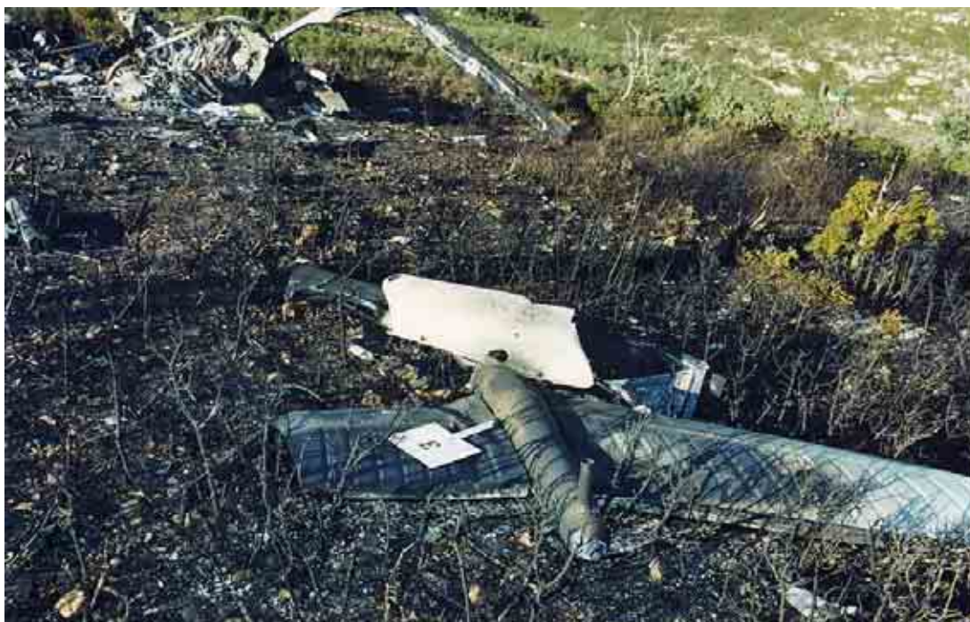
Ensemble dérives verticales et mécanique rotor arrière
