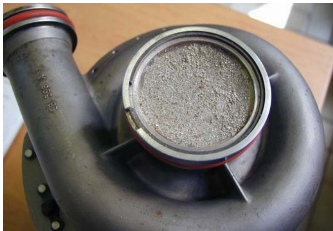
Colmatage du filtre d'entrée du turboréfrigérateur
