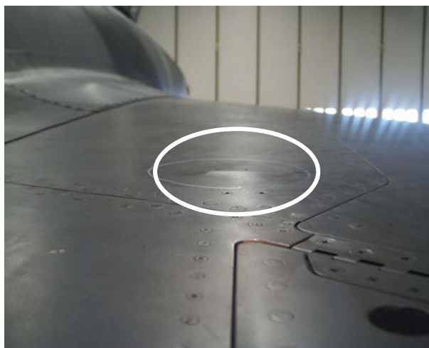
Déformation du revêtement extrados voilure droite
